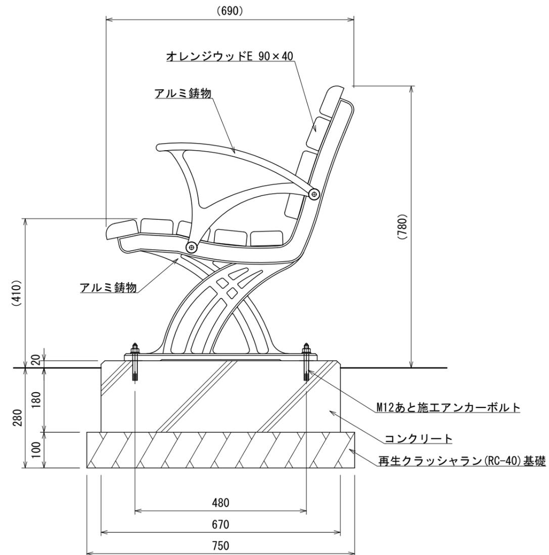
[座部断面図(2層構造)]
