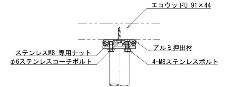
支柱取付部詳細図 S=1:5
