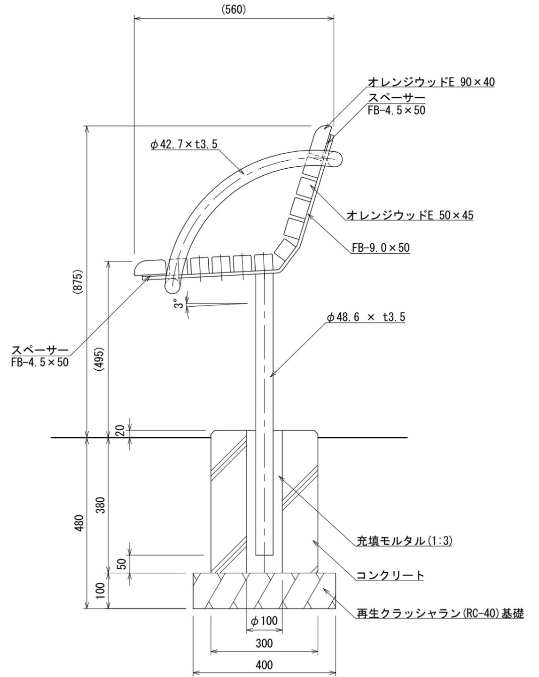
〔座部断面図(2層構造)〕
